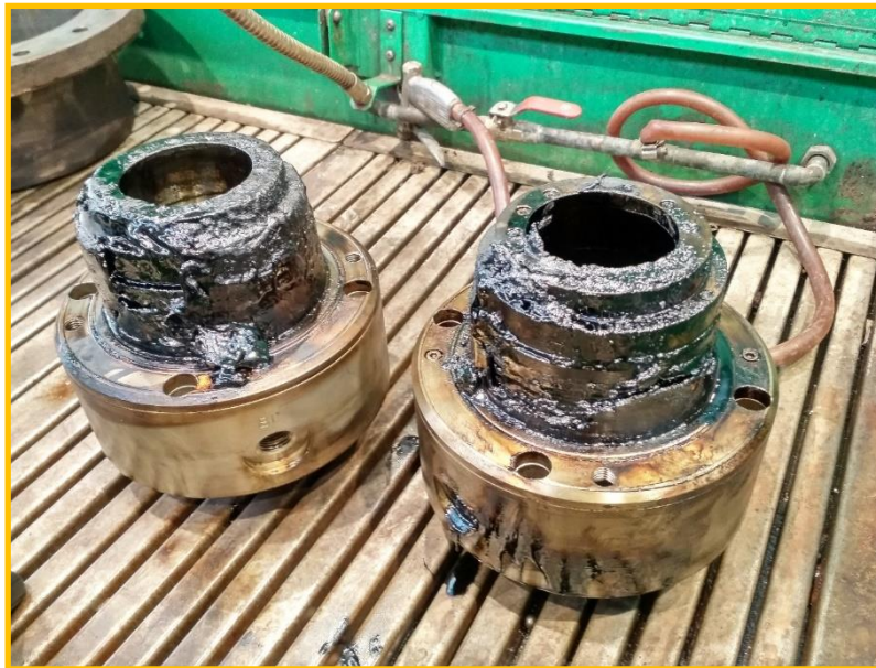
Obr. č. 10: Príklad znečistených mechanických upchávok z tohto čerpadla
