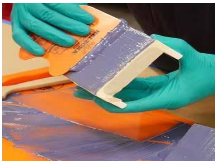
Obr. 5 Aplikácia produktu Belzona 7311
