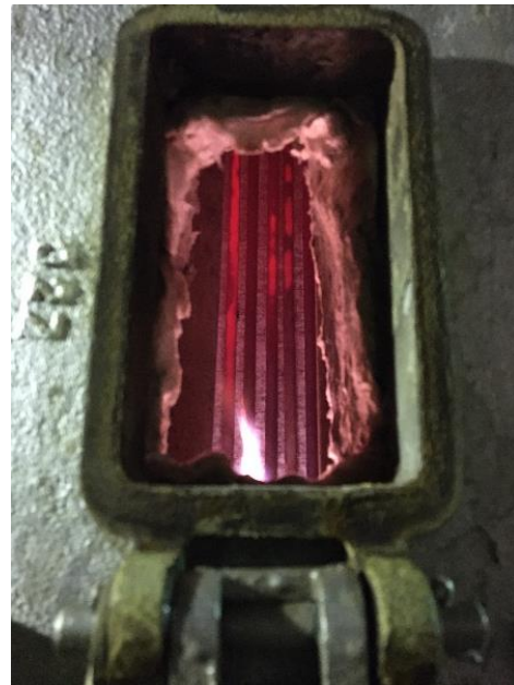
Obr.6 Fotografia rozžiarených rúr počas odkoksovania 04/2021
