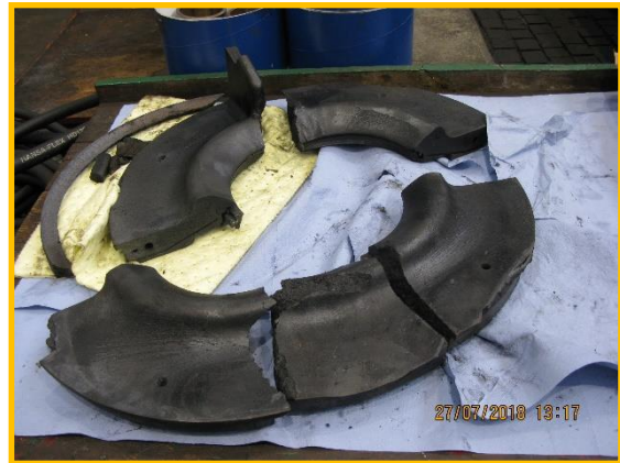
Obr. č. 8: Zaznamenané poškodenia na komponentoch kompresora
