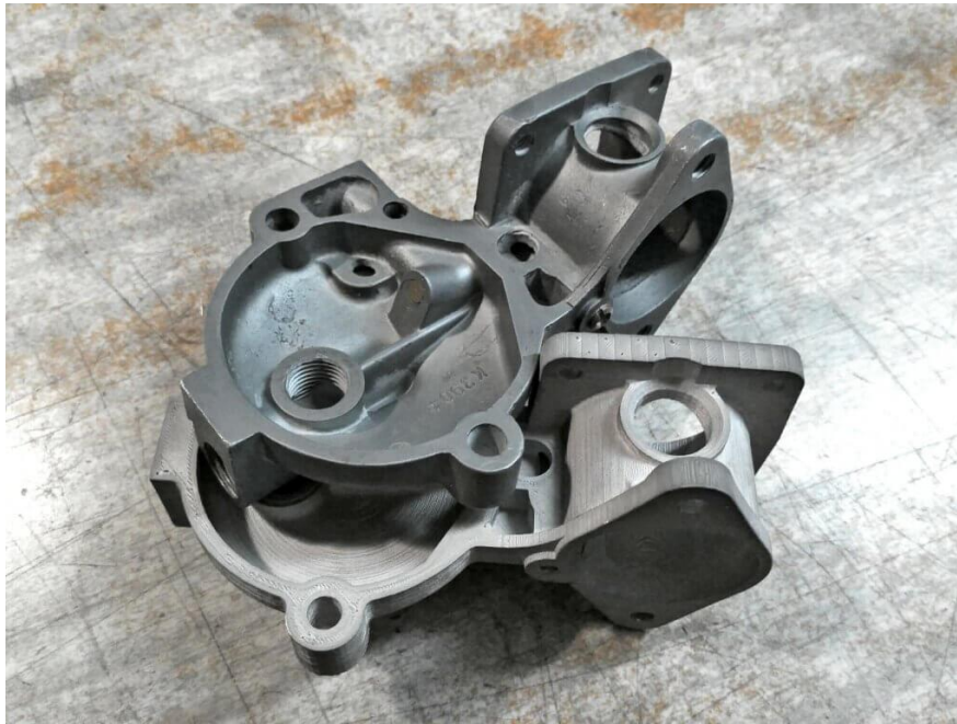
Originálny diel a jeho verná kópia z materiálu nerezová oceľ tlačaná na 3D tlačiarni Markforged Metal X
