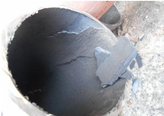
Obr.1 Nánosy koksu na vnútornom povrchu radiačných rúr.
