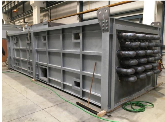
Obr.11 Nový konvekčný modul v dielni zhotoviteľa
