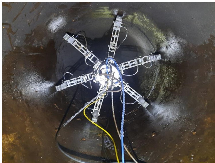
Obr. 1 Robotické zariadenie na vizuálnu kontrolu potrubia
